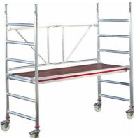
Un échafaudage roulant est un équipement de travail à structure métallique assemblée à partir d'éléments préfabriqués, posé sur le sol par l'intermédiaire de quatre roues bloquées pendant l'utilisation. Il est équipé de moyen d'accès, de planchers de travail, de garde-corps et de dispositifs de stabilisation.
